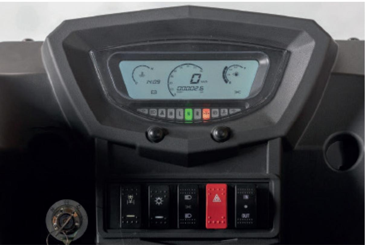
Seu painel de instrumentos é construído com display LCD com luz azul, para melhor visualização durante o dia ou à noite.
