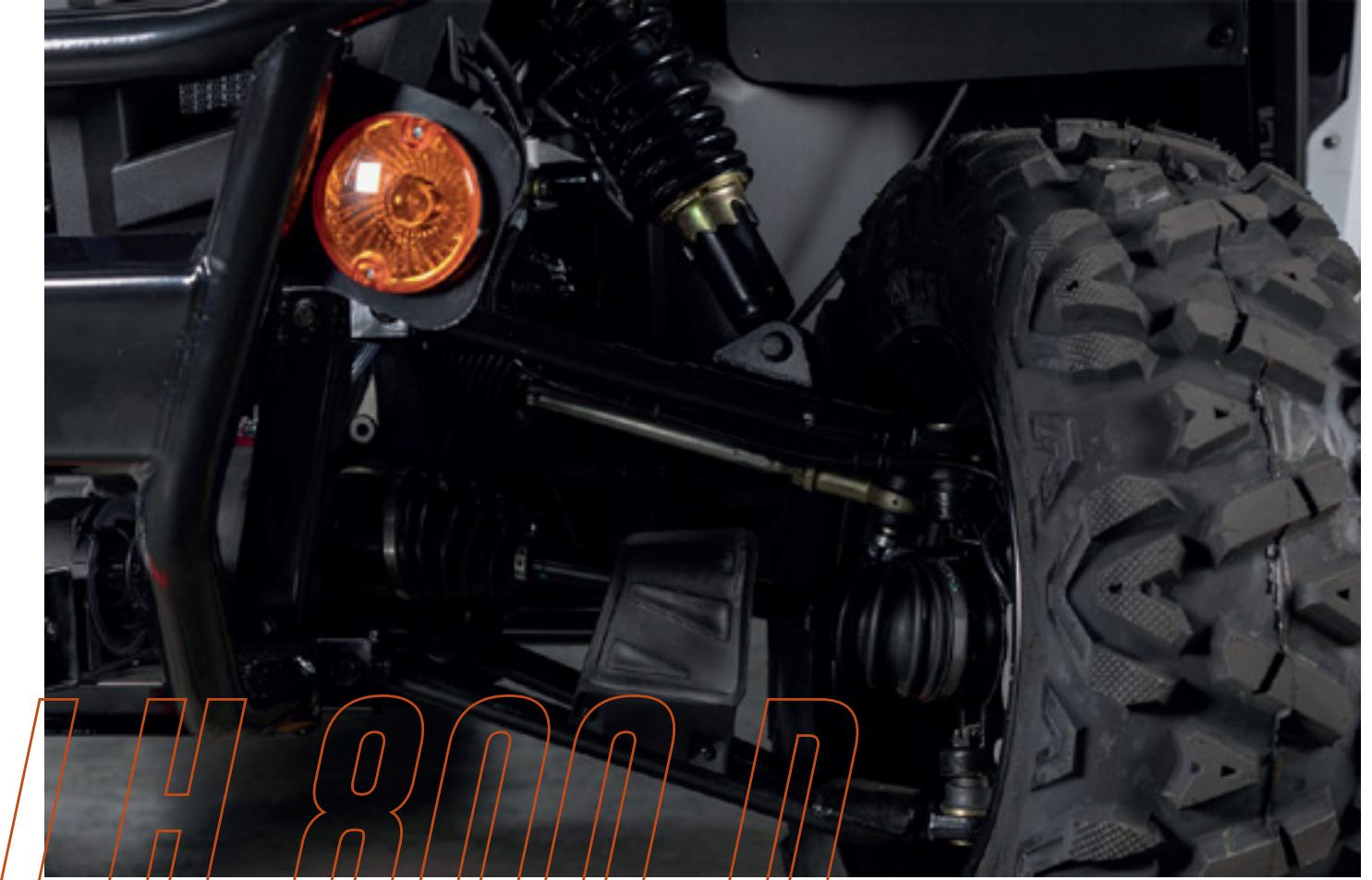
Suspensão independente, com curso de 151 mm na dianteira e 146 mm na traseira, além de interruptor eletrônico de 2WD-4WD.
